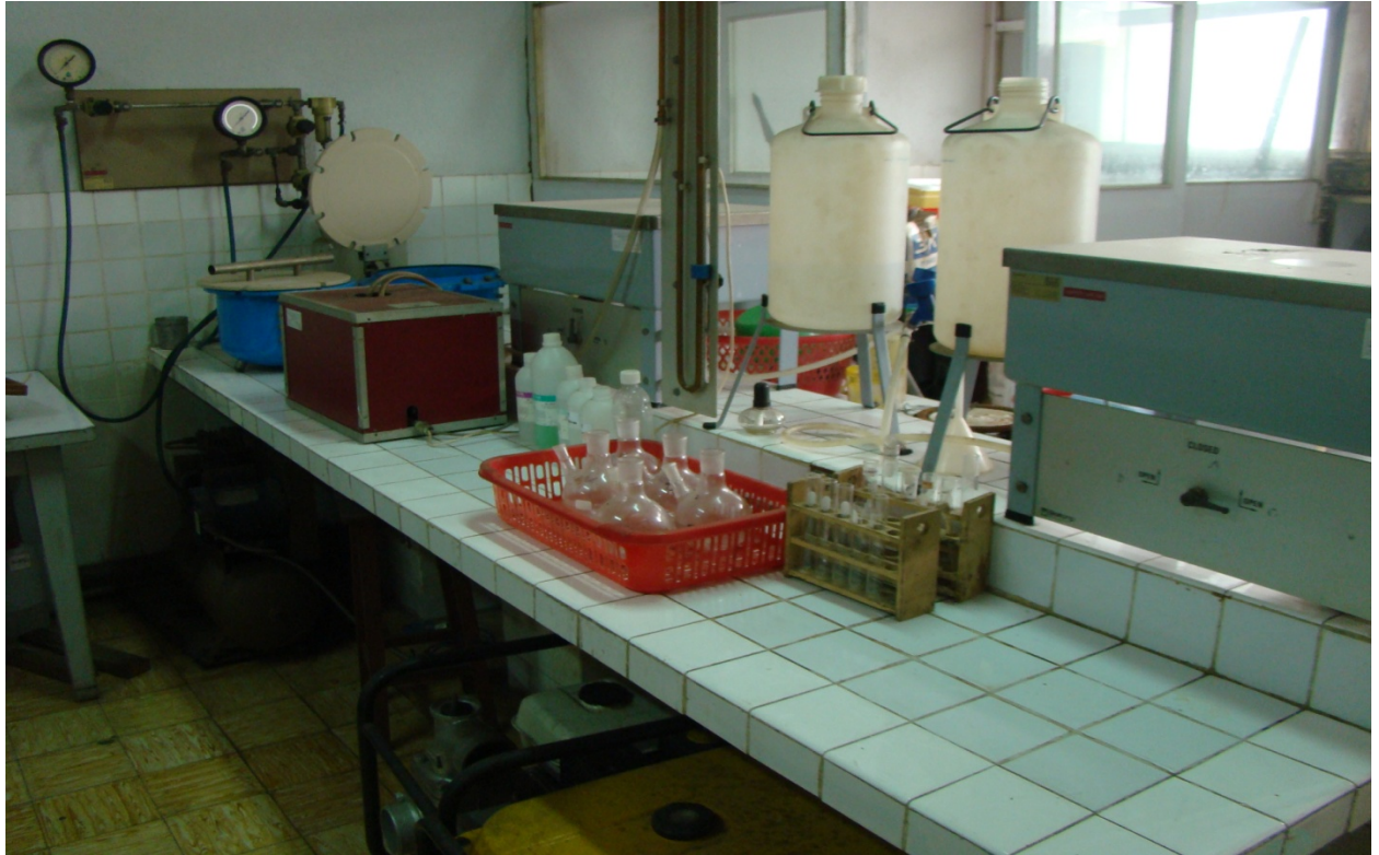
Bộ pF đo lực giữ nước và độ ẩm trong đất – phòng thí nghiệm vật lý đất bộ môn Thủy Nông.
